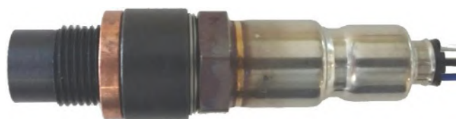
Rys. 6.4 Złożona osłona na sondę Lambda
