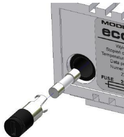
Rys. 7.1 Wymiana bezpiecznika w module ecoLAMBDA
