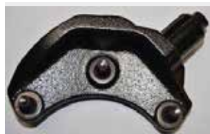
Grubość powłoki minimum 15µm
