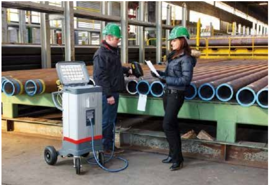
Pomiar składu chemicznego z określeniem materiału
