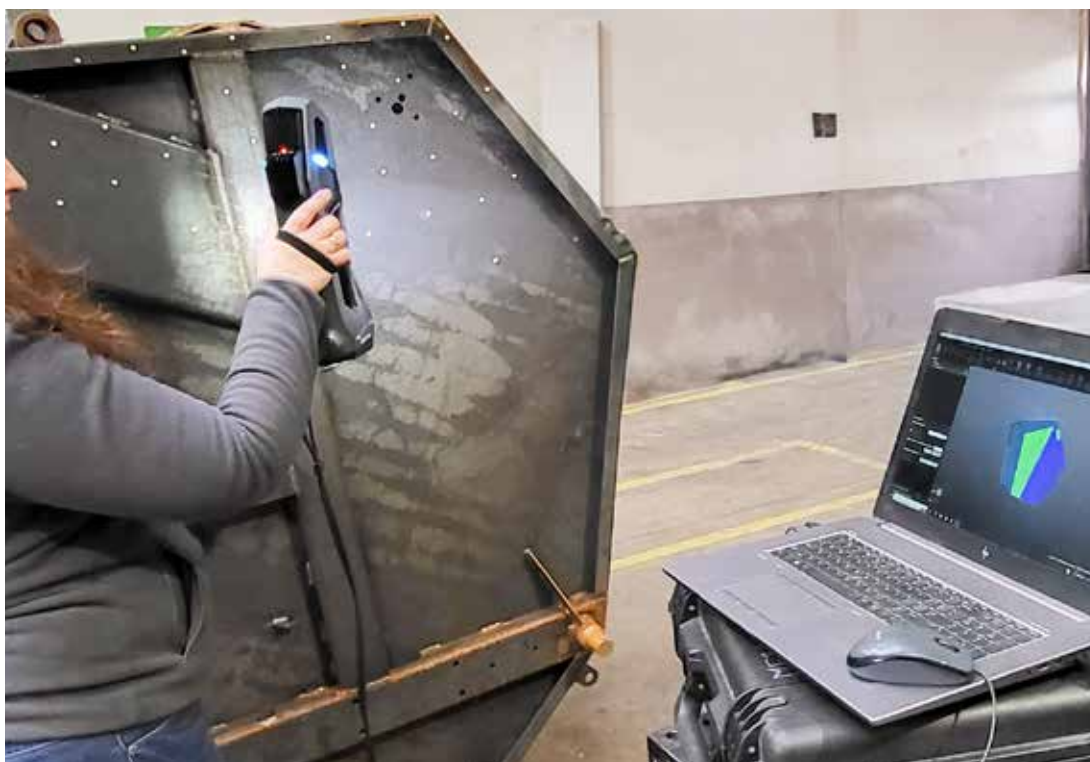
Tworzenie modeli CAD ze skanu 3D
