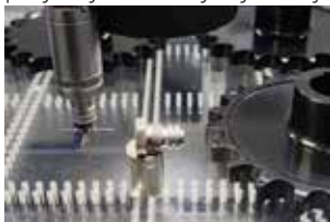
Pomiar na maszynie CMM przy użyciu sondy kątowej
