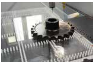
Pomiar na maszynie CMM przy użyciu sondy stykowej
