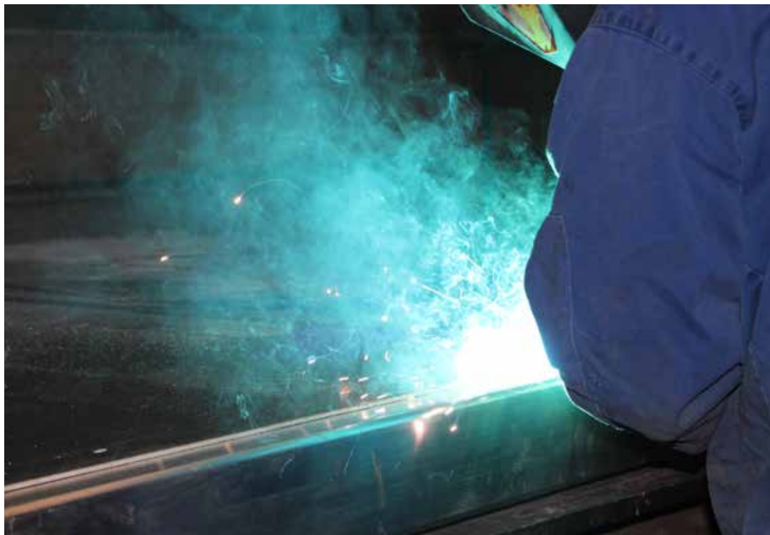
Zakres spawania stali węglowej wg. WPQR od 0.5 do 40mm (MIG/MAG)
